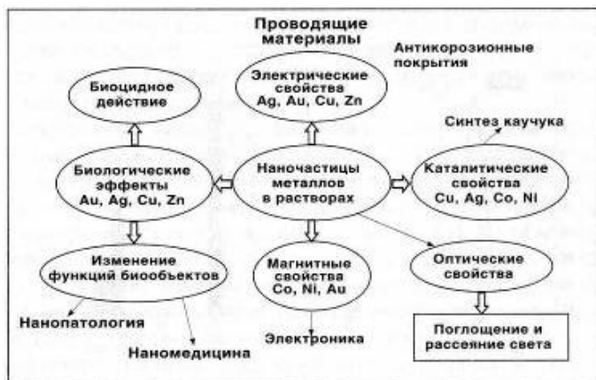
Рис. 3. Свойства наночастиц металлов и возможности их применения.
